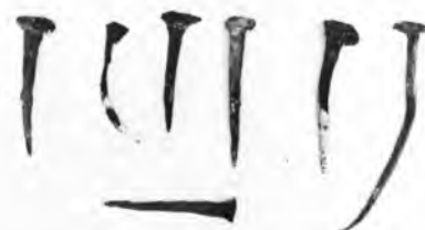
Φέραι Έβρου. Παναγία η Κοσμοσώτειρα: α-στ) Η βάση του τρούλου, μετά τις εργασίες, ζ) Καρφιά από τις ξυλοδεσιές στη βάση του τρούλου.
